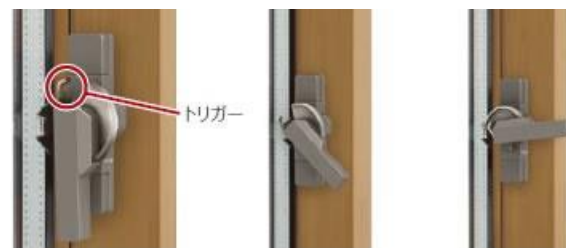
障子が確実に閉まっていない場合、クレセントが最後まで回らない仕組みになっているため空かけ状態になる前に気づくことができます。
